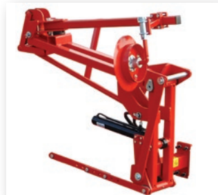
Trazadores dentro del ancho de trabajo con trazado central (solo para bastidores plegables)
